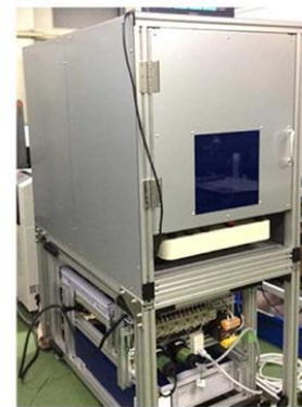
開発したフラットパネル用溶着機
